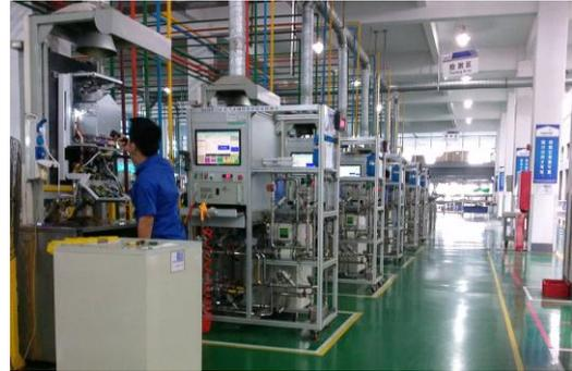
图 15 迪森家居壁挂炉自动化生产线、检测设备局部图
