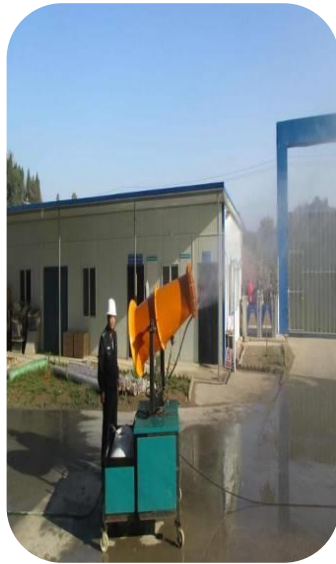
2. 在粉尘较大的部位使用降尘雾炮机
