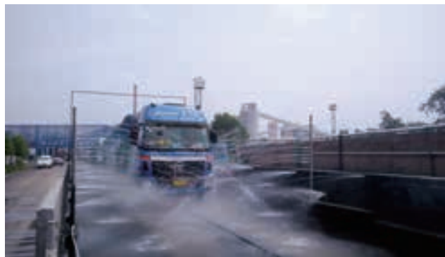
冲车台冲洗运煤车辆
