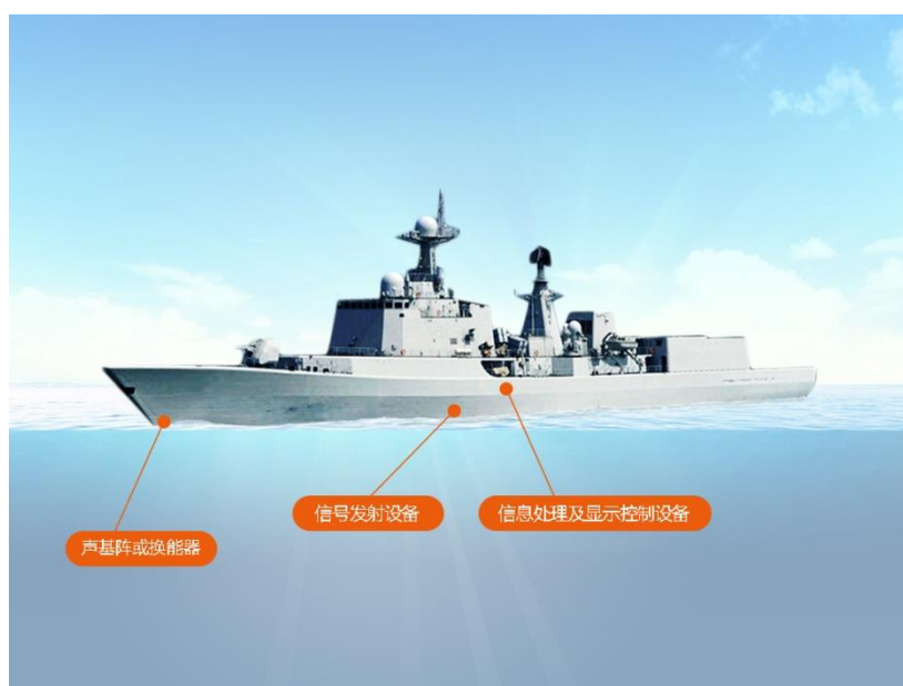
图：水声信息传输装备在海洋通信体系中的应用示意图
