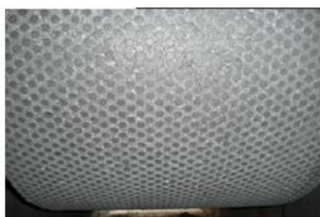
工作 8000 小时后的 高压辊磨机 辊面
