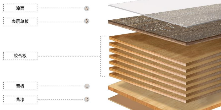
多层实木复合地板结构示意图
