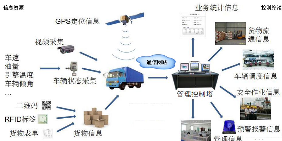
图 24：物流供应链控制塔系统组成
