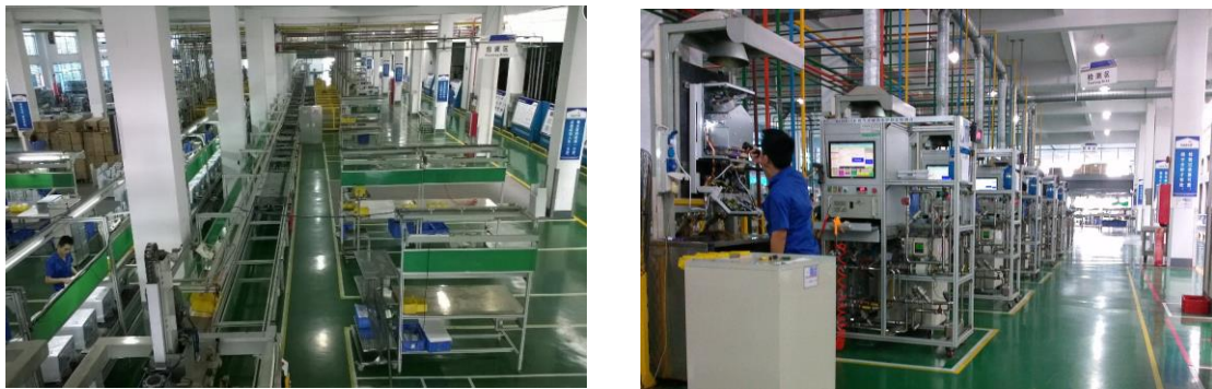
图 12 迪森家居壁挂炉自动化生产线、检测设备局部图
