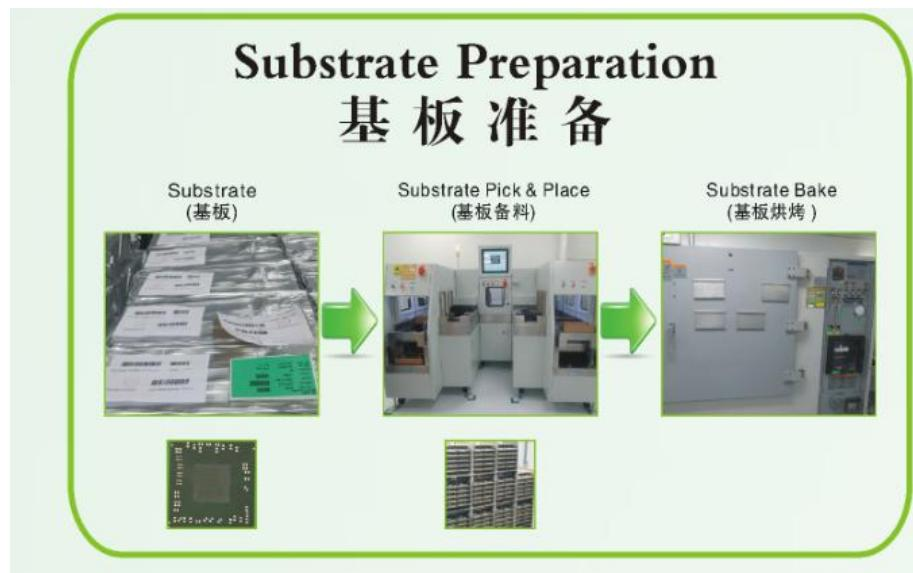
该步骤主要将基板从真空包装中取出，通过机械手臂，将基板从托盘转移至专用载具中，随后置入烘箱烘烤，从而去除基板中的湿气。
