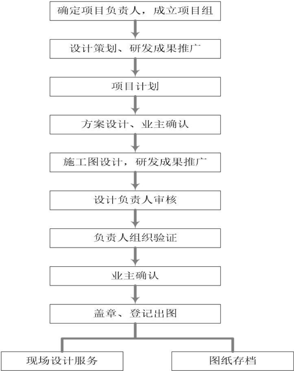
图表 9 施工设计业务流程图
