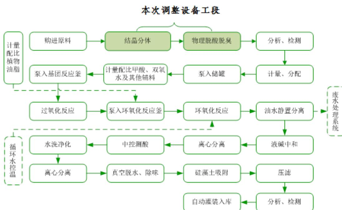
“年产 6 万吨环氧植物油脂增塑剂项目”包含原材料分提预处理工艺，系增塑剂生产环节中原材料预处理环节，主要通过应用公司自主研发的结晶分体和脱臭脱酸两个分离步骤：结晶分体主要针对普通原材料组分内不同熔点的油在不同温度下进行结晶分离，也就是在不同的温度下把不同熔点的油分开，进一步提升原材料一致度，增加产品品质；脱臭脱酸主要指利用高温、高真空将原材料中的酸价、味道等脱除，提高产成品性能以满足食品、医药领域的应用等要求。
