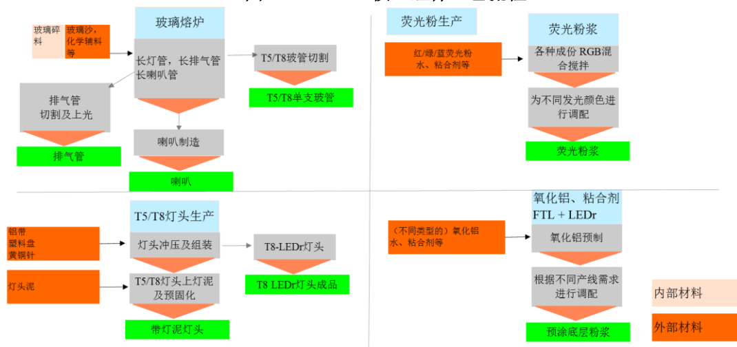
图 LPD T5/T8 核心组件工艺流程
