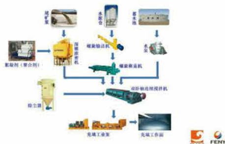
山东黄金源鑫矿业有限公司充填系统
