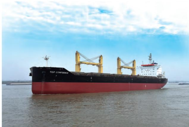
▲ “海骆驼”型48,500载重吨大型重吊杂货船
