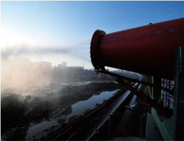
煤场防尘雾炮装置
