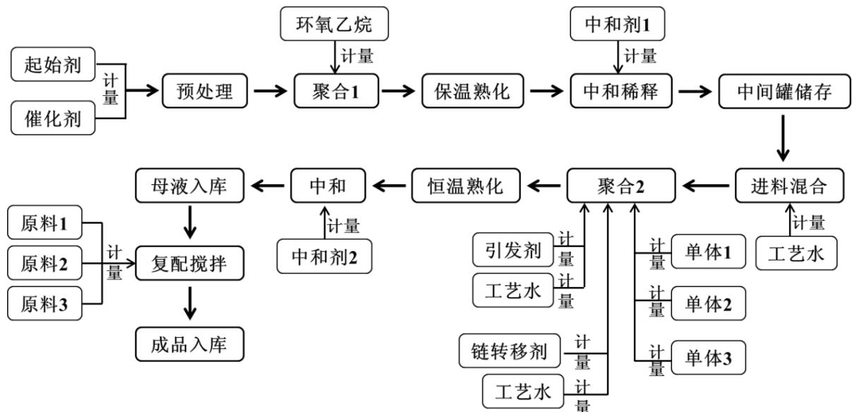
高效减水剂生产工艺流程
