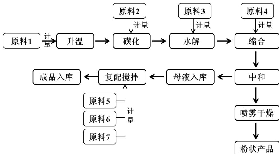
脂肪族高效减水剂生产工艺流程图:
