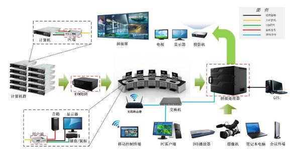
②会议室:会议市场开始向电信网、广播电视网和计算机通信网融合方向发展,通过传输线路及多媒体设备,将声音、影像及文件资料互传,实现即时互动沟通。要求会议室系统能够处理前端信号源类型和格式多样化,甚至要求视频会议调度或会商系统和控制室指挥调度中心融合应用。
