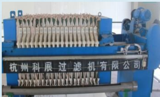
污水处理设备：全自动板框压滤机
