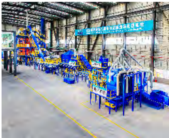
废线路板绿色处理线
