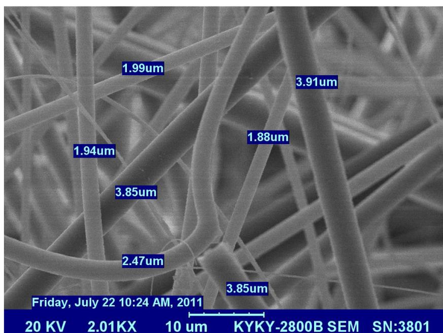
(高倍显微镜下的离心棉内部结构图)
