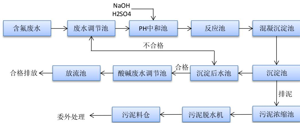
3、典型废水回用及零排放工艺流程图
