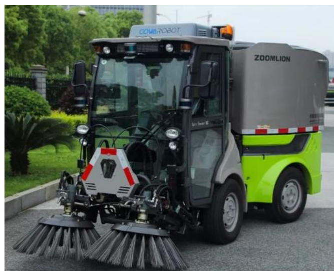
中联环境 SHZ18CAI 型号无人驾驶小型扫路车
