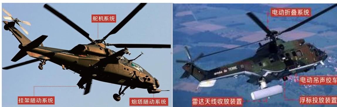
公司机载悬挂/发射装置类产品为以伺服控制技术为基础的随动系统类产品，主要由伺服驱动器、电传动机构、伺服电机等部件构成，具有高集成小型化、通用化、模块化、高精度、智能化等特点，应用了高精度伺服驱动和系统智能控制、高精度高承载传动、伺服控制和传动力学系统仿真、机电一体化融合等设计技术。
