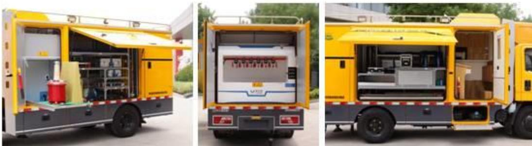
电力不停电作业装配预防性试验车
