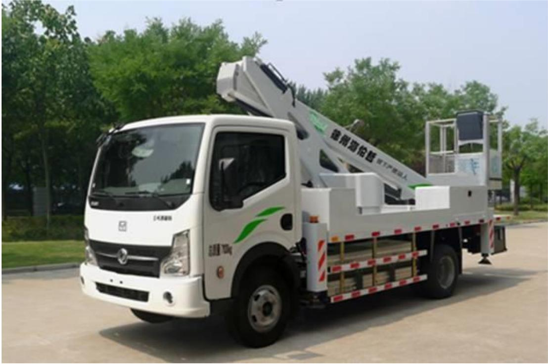
电动新能源18米伸缩臂高空作业车
