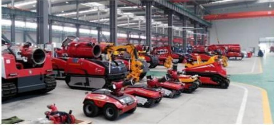
消防机器人装配生产线
