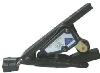
踏板式电子油门踏板总成
