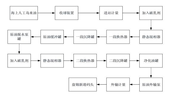
一段沉降罐脱出的污水排至污水处理系统;二段沉降罐脱出的污水经抽底水 泵至一段沉降罐(或污水处理系统)。
