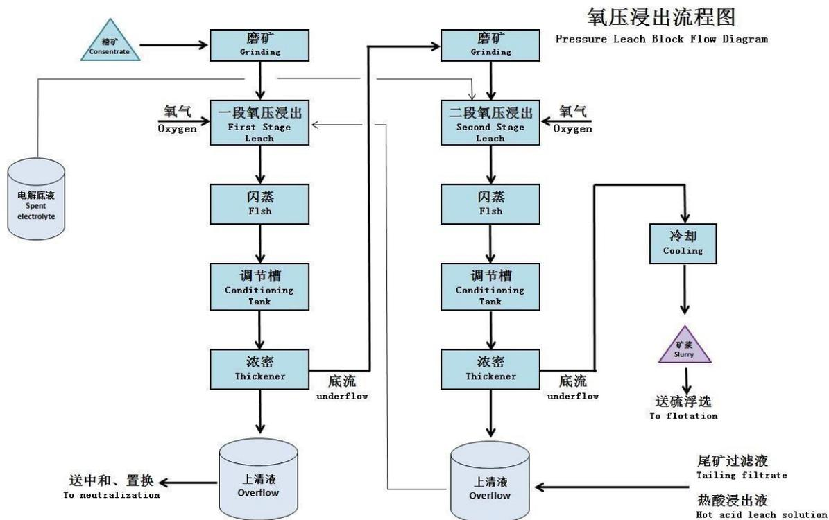
丹霞冶炼厂锌氧压浸出工艺流程图
