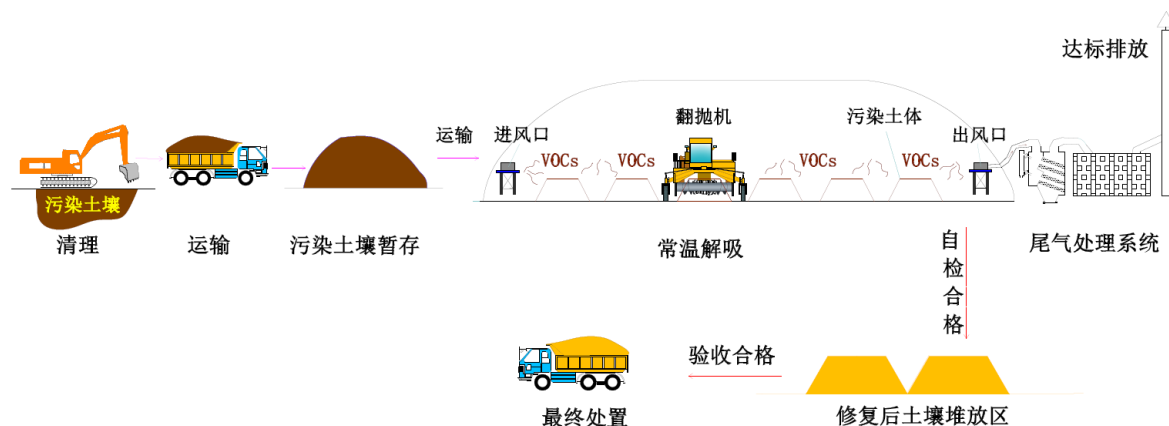
常温解吸技术工艺流程示意图
