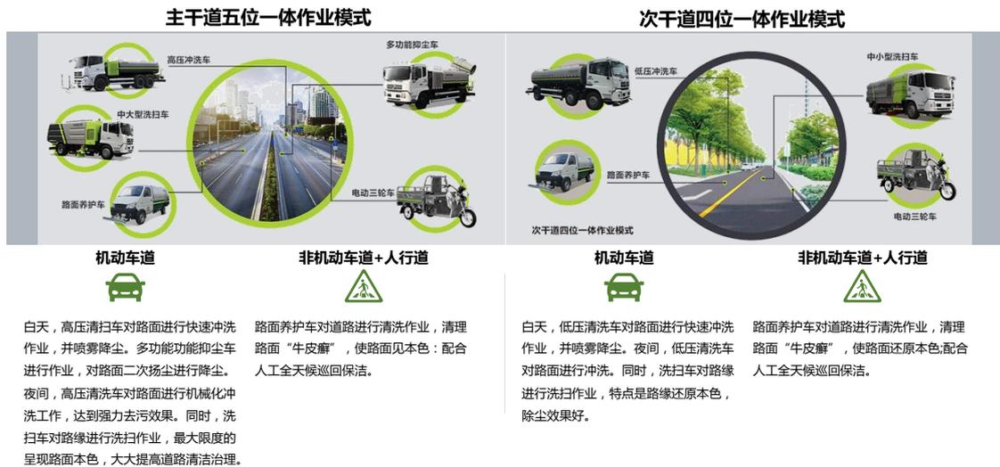
道路清扫保洁根据道路类型可分为“主干道五位一体作业模式”和“次干道四位一体作业模式”。其中，“主干道五位一体作业模式”旨在通过高压冲洗车、中大型洗扫车、路面养护车、多功能抑尘车、电动三轮车等环卫装备保证城乡主干道的清洁，“次干道四位一体作业模式”则旨在通过低压冲洗车、中小型清扫车、路面养护车、电动三轮车等环卫装备保证城乡次干道的清洁。
