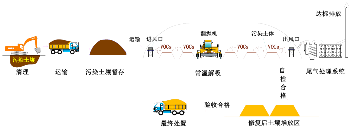
常温解吸技术工艺流程示意图
