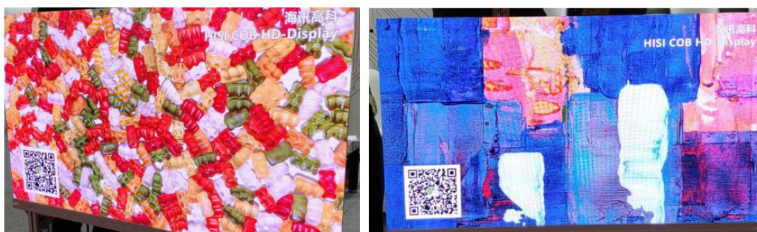
海讯高科研发、生产的COB技术LED显示屏（图为55寸通电显示效果）
