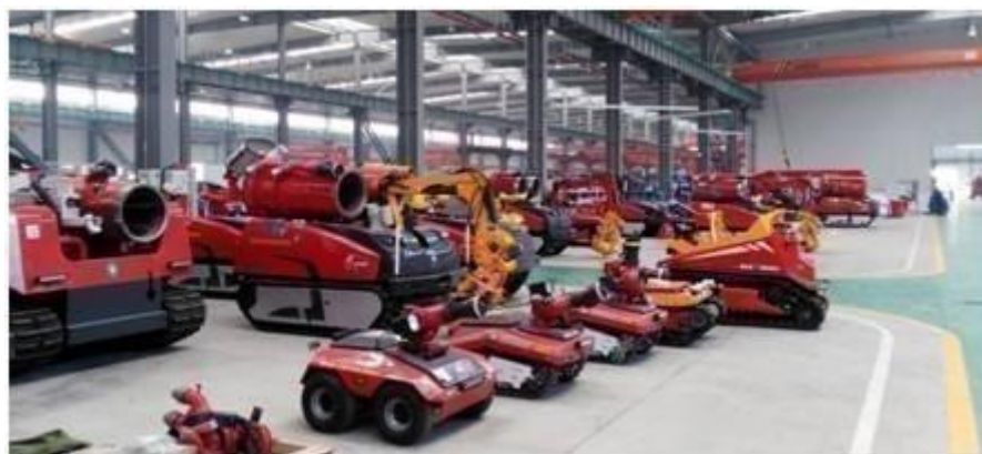
消防机器人装配生产线
