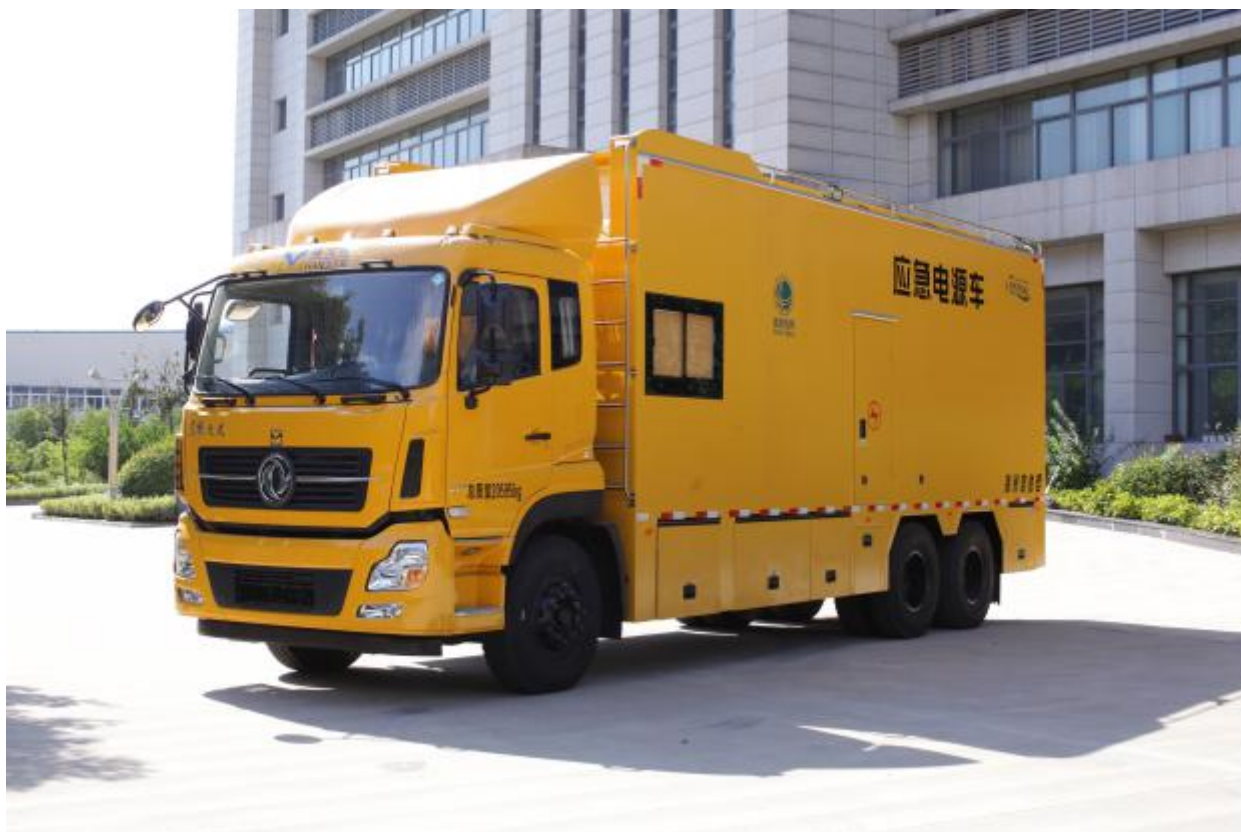
500kW应急电源车
