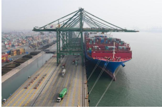
该轮由中远海运集团旗下南通中远海运川崎船舶工程有限公司建造，于今年1月16日正式交付，船长400米、型宽58.6米、型深30.7米，最大载重量达19.7万吨，甲板面积比4个标准足球场还要大，是目前世界上尺度最长的船舶之一，代表着我国船舶制造业进入世界领先行列。该轮服务于海洋联盟的欧洲航线，此航线从天津港出发，挂靠华北和华东地区各主要港口，途经新加坡抵达德国、比利时、荷兰、希腊等“一带一路”沿线国家，是服务“21世纪海上丝绸之路”的黄金航线。
