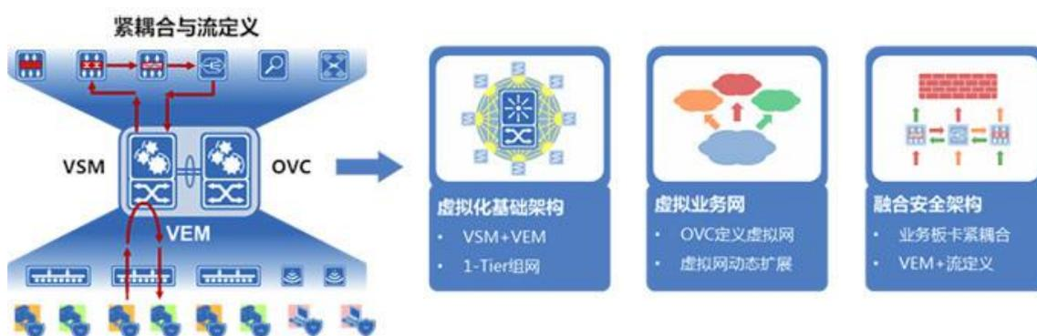
(1) VSM (Virtual Switching Matrix) 虚拟交换矩阵：L2~7 层 N：1 虚拟化技术，可以将多台设备虚拟为一台逻辑设备。VSM 不仅实现了网络资源的虚拟化，还实现了安全和应用交付资源的虚拟化，提高整网性能、可靠性与弹性。
