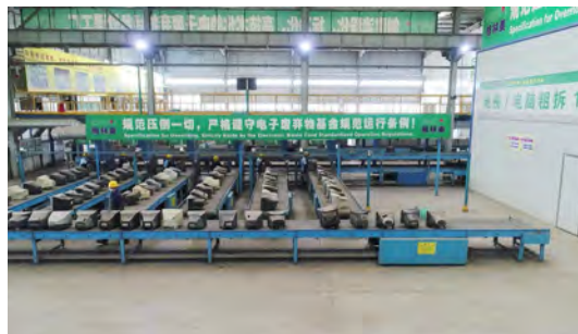
格林美流程化废家电拆解线
