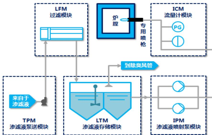
泰欣环境渗滤液回喷系统拥有自主专利技术，具有无需人工操作，自动控制喷量，自动控制炉温等特点。泰欣环境可根据客户的不同需求，制定出相应的解决方案。
