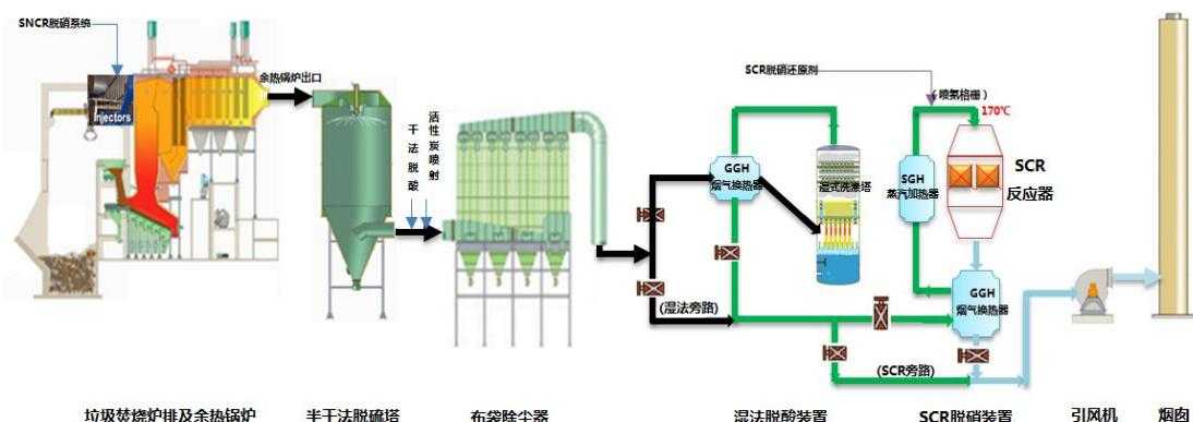
垃圾焚烧烟气净化系统技术由脱硝、脱酸、除尘、除二噁英和重金属等各独立单元优化组合而成。组合的原则和目的，是使整个烟气处理系统能有效地、最大化地处理去除存在于烟气中的各种污染物，并经济可行。
