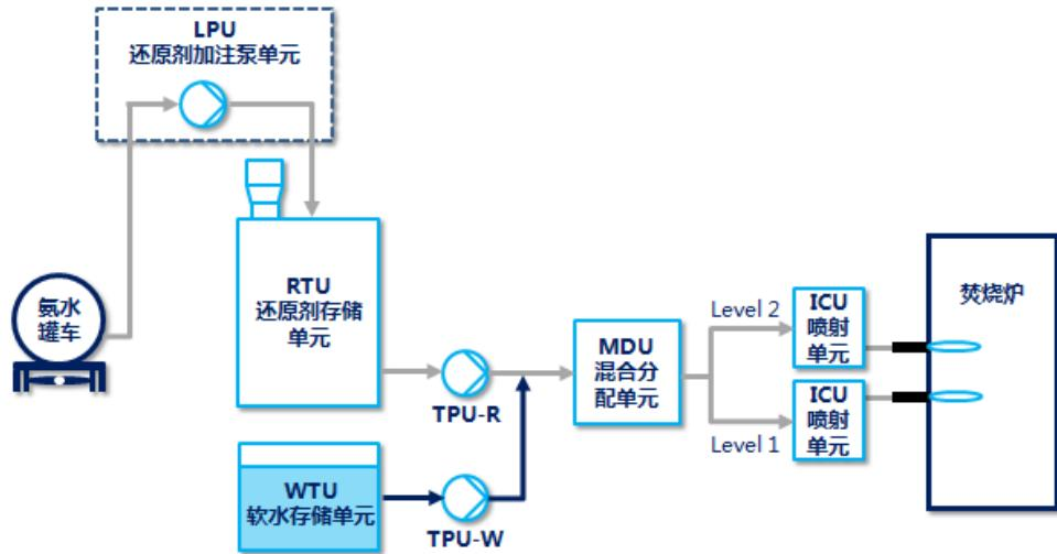
SNCR 系统技术相对简单，无需使用催化剂，系统一次性投资较低，但是脱硝效率一般为 30% 左右，效率较低。
