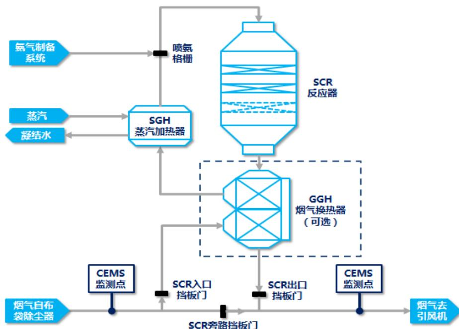
相较 SNCR，SCR 系统使用催化剂，工作温度低，稳定性强，脱硝效率高达 90% 以上，但是 SCR 工艺设备投资成本、催化剂成本较高。
