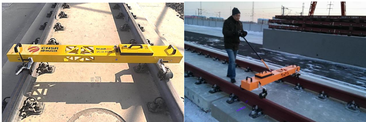
图：轨道扣件检测系统
