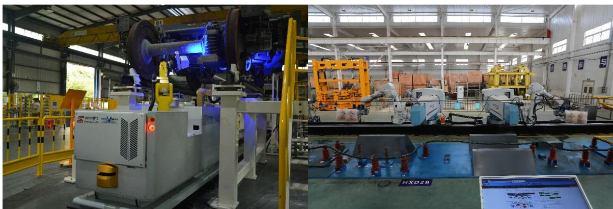
图：车底智能巡检机器人
