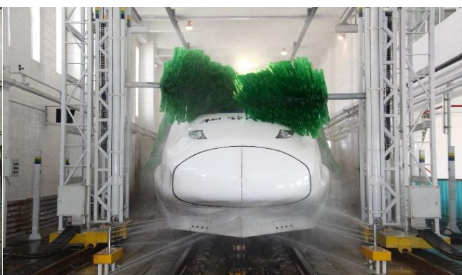
图：动车组列车外皮清洗机
