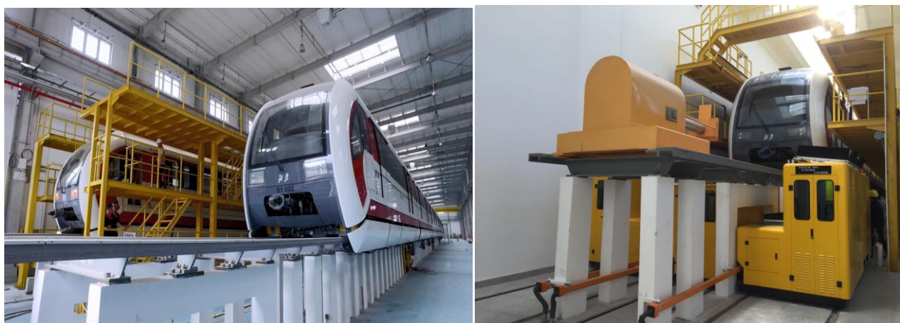
图：中低速磁浮车辆工艺检修系统
