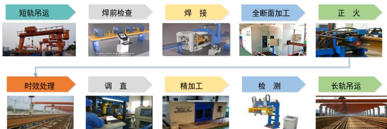
图：焊轨基地钢轨焊接核心设备
