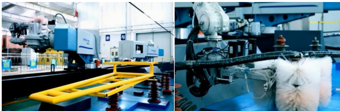
图：车顶智能清洗巡检机器人
