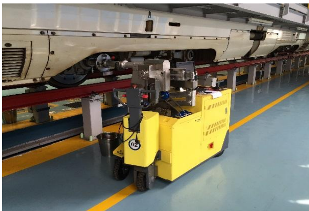
图：空心车轴超声波探伤机
