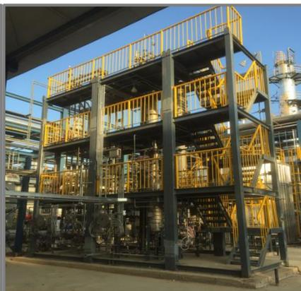
3. 报告期内，公司具有自主知识产权的催化湿式氧化技术在福建美得石化项目、延长石油轻烃综合利用项目上得到良好应用，左图分别为两个现场的CWO装置，该装置撬装，解决了高浓度难降解的废水处理。
