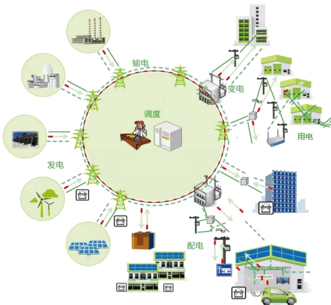
(电力系统各环节架构示意图)
