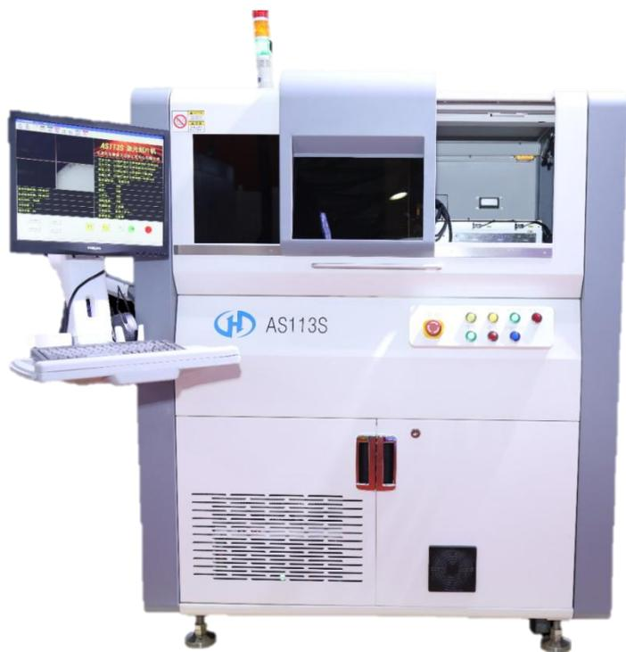
激光划片机主要由光学系统、视觉系统和控制系统构成。标的公司所生产的激光划片机采用双 CCD 系统、配合 8 轴高速控制卡，以保证设备的工作效率和工作精度。
