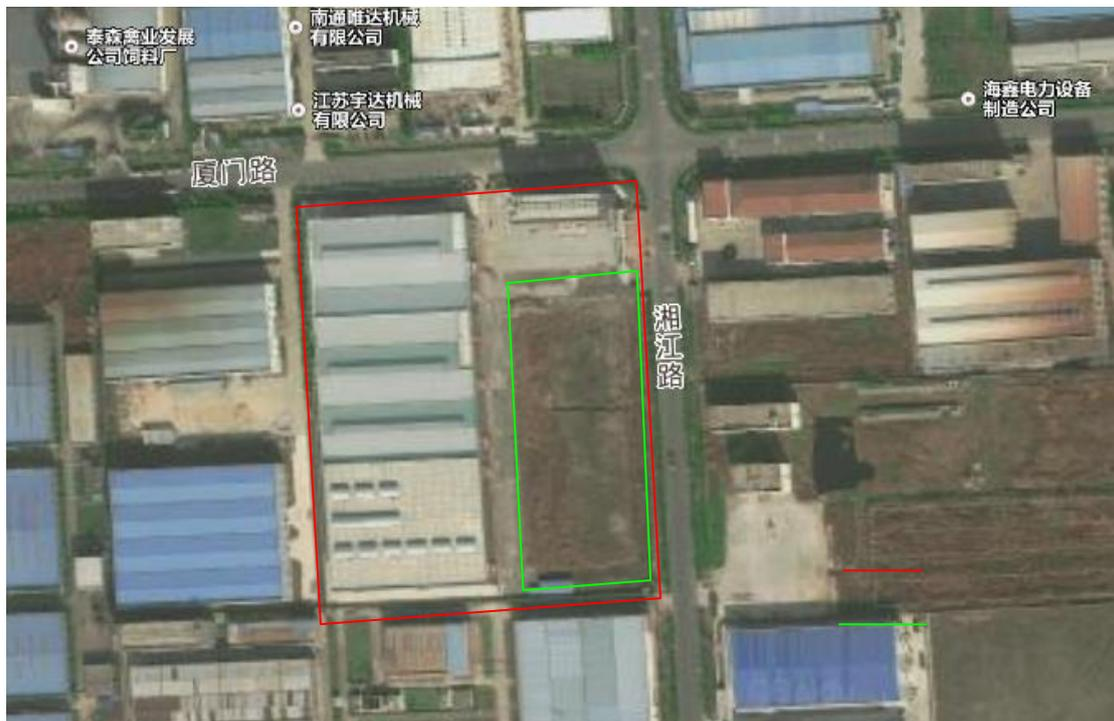
厂区内主要建筑物是原年产1万套高性能智能控制阀建设项目生产车间、综合楼、门卫和配电房等。厂区人流入口面向湘江路（靠近厦门路），便于行人和轿车进出；厂区内主要建筑物是原年产1万套高性能智能控制阀建设项目生产车间位于厂区西部，综合楼布置在厂区的东北角；本项目厂房位于综合楼南侧空地。厂区物流进出口布置在厂区东南角，面向湘江路，便于原材料和产品运输。建设单位拟在综合楼周边集中布置绿地，在厂区内沿厦门路集中布置绿化带，厂内道路两侧种植乔木和灌木等植物。厂区沿主要厂房四周都留有消防通道或布置了运输道路，车道宽度不小于4m，便于大型消防车的通行，厂区内按规范设置了室外消火栓。
