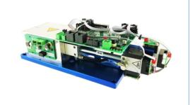
舒茨股份联合德国 WiTec GmbH 全新推 出紫外吸收气体传感器,利用先进的 紫外吸收原理,精确检测二氧化碳、 臭氧、硫化氢等气体。
