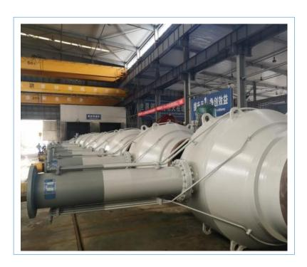
成功交付中俄石油天然气管线东线 56 寸 900 磅全焊接球阀
