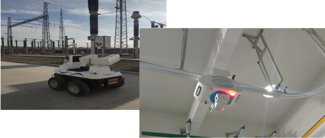
图：变配电所智能巡检轮式机器人
