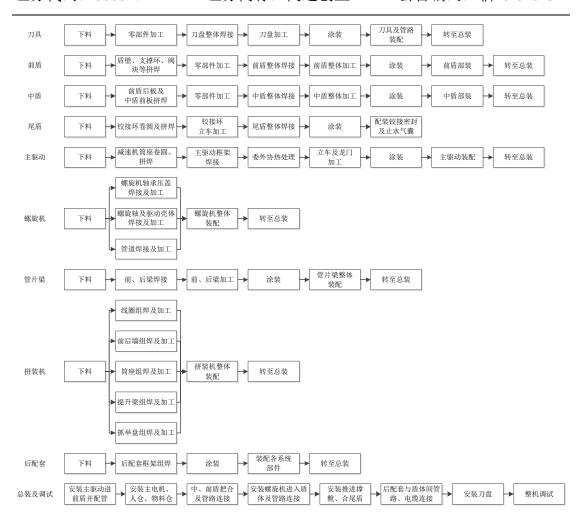
三三工业生产部门根据销售部门提供的销售预测、销售计划,制定主机装配计划,并根据装配计划制订采购及自制生产计划,按照计划完成盾体、主驱动、螺旋机、管片梁等的生产与整盾总装机调试。
