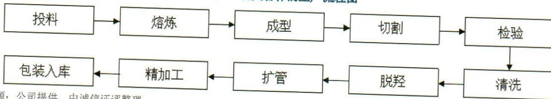
图 5：石英管棒的生产流程图
