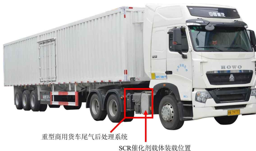
图：柴油重型商用货车尾气后处理系统（国五）与 SCR 载体装载位置示意图
