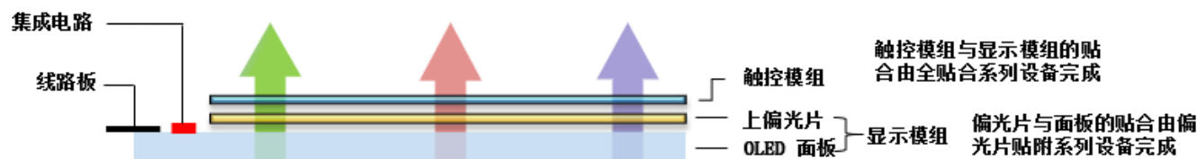
OLED显示器件结构图
