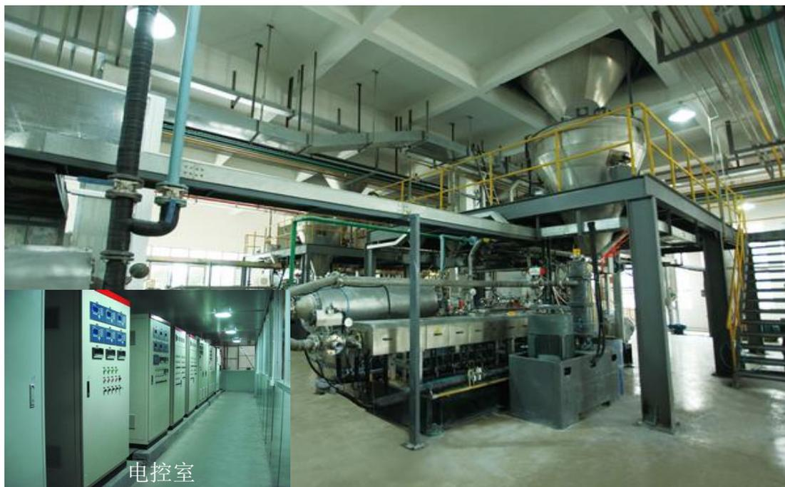
双螺杆全自动连续生产线局部图
