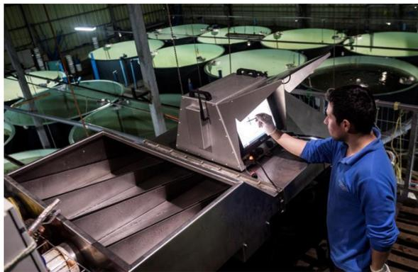
幼鲑生长到一定重量后投放至海水养殖场，在投放过程中，采用专业红外设备对进入海水养殖场中的鲑鱼进行逐条计数，与系统中已记录的幼鲑数量进行核对一致后，作为海水养殖场中鲑鱼数量的起点。在海水育肥阶段，鲑鱼养殖在封
