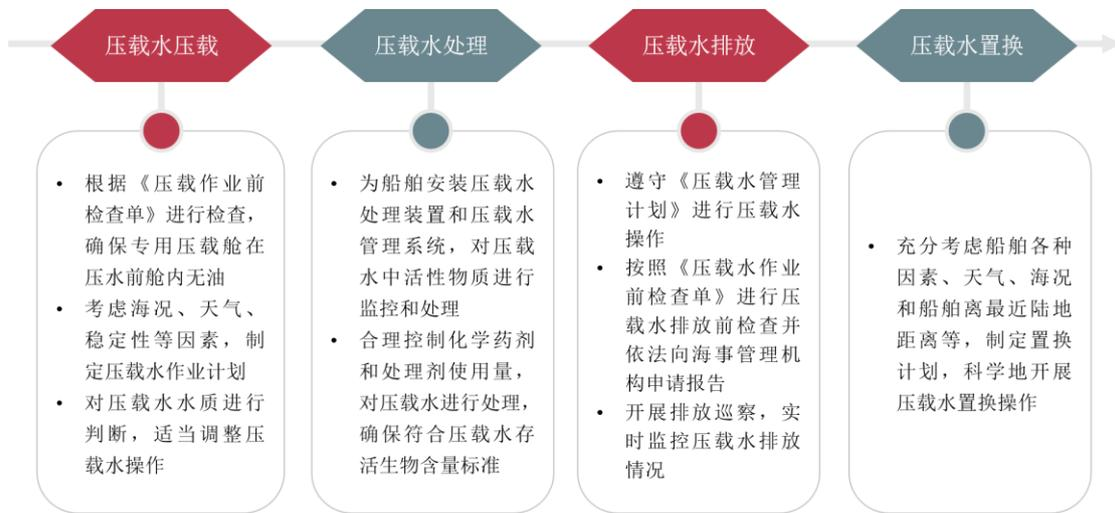
图注：压载水压载、处理、排放、置换等环节操作要求
